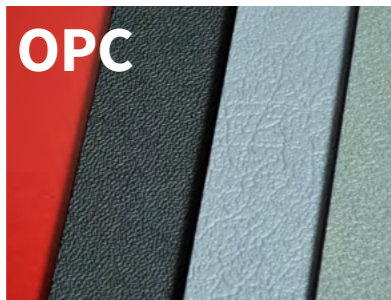
OPC (opak polykarbonat) används främst till skydd och detaljer för industri, resväskor och paketeringslösningar.
